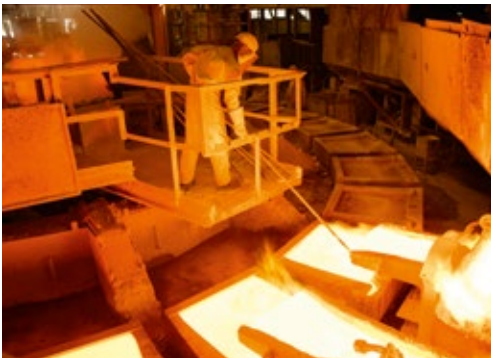
Mitarbeiter am Anodengießrad
