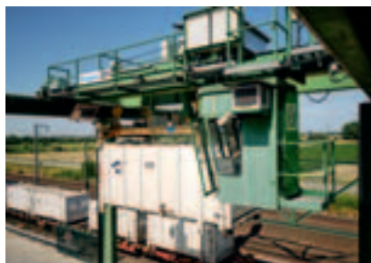
Mit dem Kran werden die vollen Container auf den Zug verladen.
