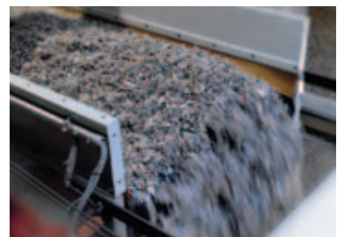
Ersatzbrennstoff wird von einem Förderband in einen Container befördert.
