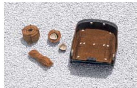
Unterbau eines Autositzes mit Kokosfasern
