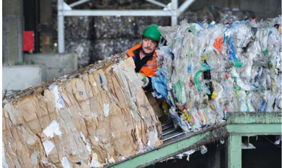
Kartonagen und Folien werden zu Ballen gepresst
