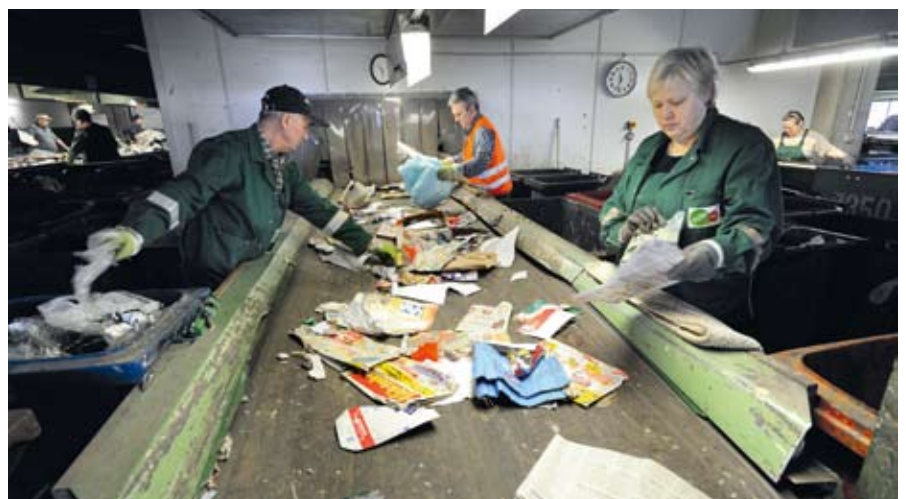
Aus dem Mischpapier werden die maschinell nicht erkannten Störstoffe aussortiert
