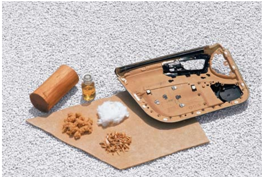
Türinnenverkleidung aus naturfaser-verstärktem Kunststoff
