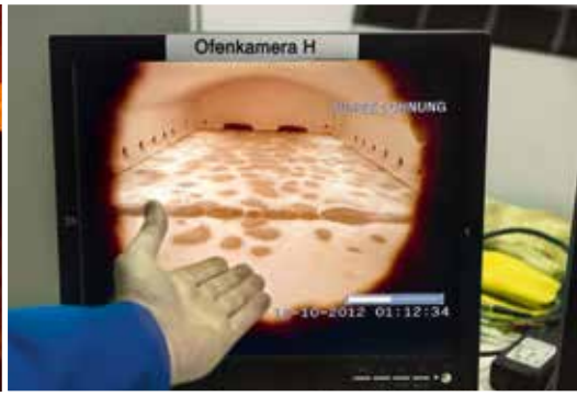
Sichtkontrolle der Schmelzwanne mittels „Ofenkamera“
