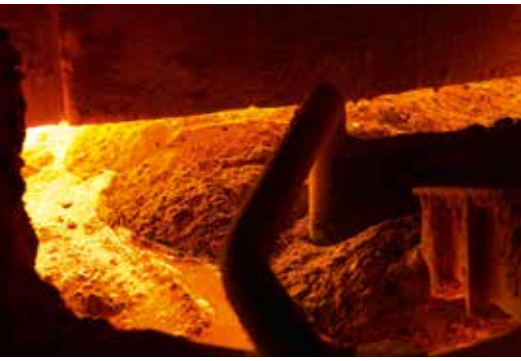
Blick in die Schmelzwanne an der Einfüllöffnung
