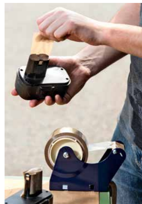
Batteriepole mit Klebeband isolieren
